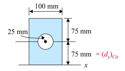
$$I_{x} = \left(\frac{bh^{3}}{3}\right)_{\text{Re}ct} - \left(\bar{I}_{x} + Ad_{y}^{2}\right)_{Cir}$$
